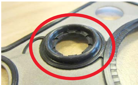
Testata con scanalature fresate: es. (kit di riparazione) 4.20525 o 4.91176 Dal motore n. 357749
