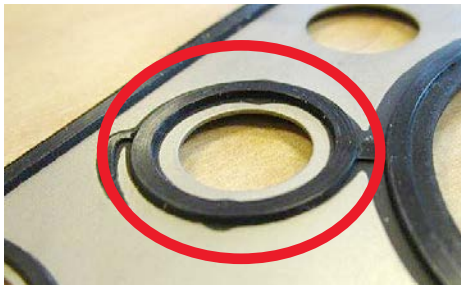
Testata cilindro con superficie di tenuta livellante: ad esempio 4.20405 o 4.91175 (kit di riparazione) Fino al motore n° 357748
